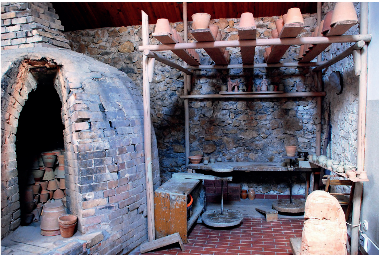
Fig. 13. Zabytkowy, kopułowato sklepiony piec garncarski po lewej stronie i stanowisko pracy garncarza z dwoma toczkami po prawej, 2016, fot. G. Pabian • Original, pottery kiln with a semispherical top at the left side; potter's site, with two wheels at the right side, 2016, photo G. Pabian
