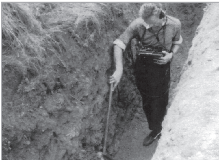
Il. 5. Geolog z radiometrem podczas pomiarów gamma w rowie poszukiwawczym. Zdjęcie pochodzące z badań prowadzonych przez Zakład Przemysłowy R-1 w Kowarach na Dolnym Śląsku. Zapewne tak samo wyglądały pomiary w Miedzianej Górze i Kielcach; źródło: tamże, s. 58
