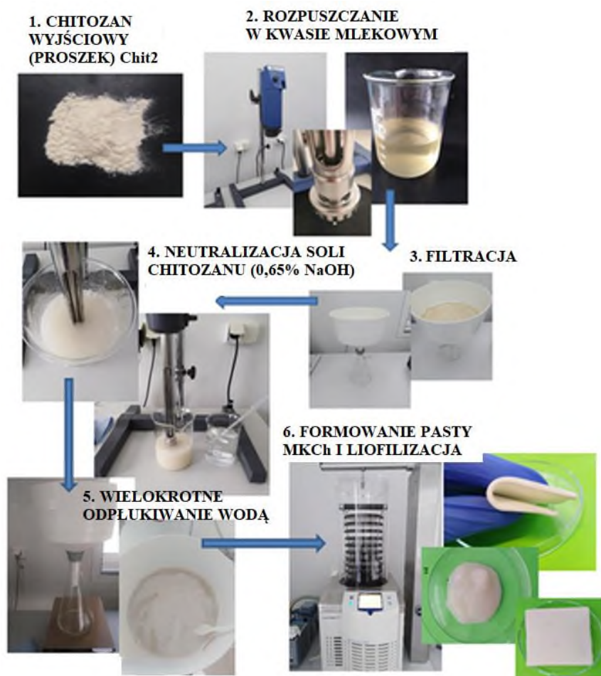
Ryc. 4 Schemat przygotowania macierzy chitozanej o strukturze gąbki (ChbM-s).
